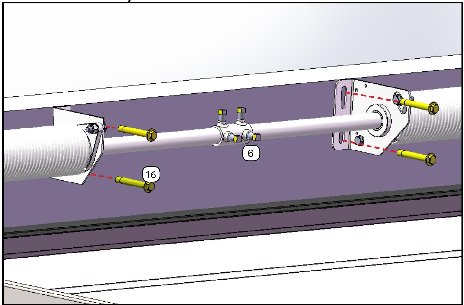
показана система с двумя валами, соединенными муфтой. В зависимости от размера ворот комплектация может быть с единым валом без муфты и с одной пружиной
