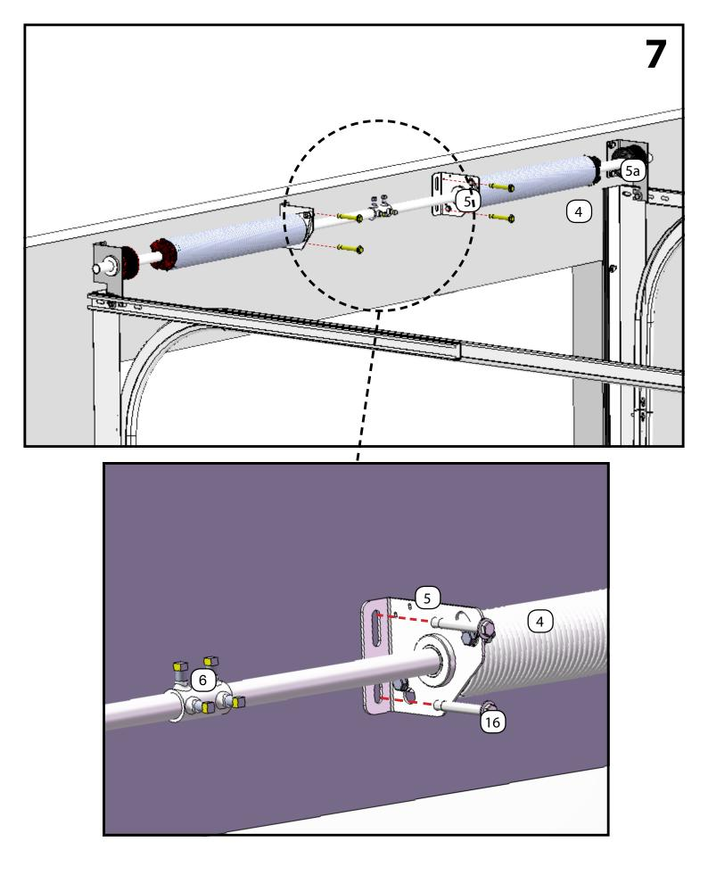
показана система с двумя валами, соединенными муфтой. В зависимости от размера ворот комплектация может быть с единым валом без муфты и с одной пружиной
